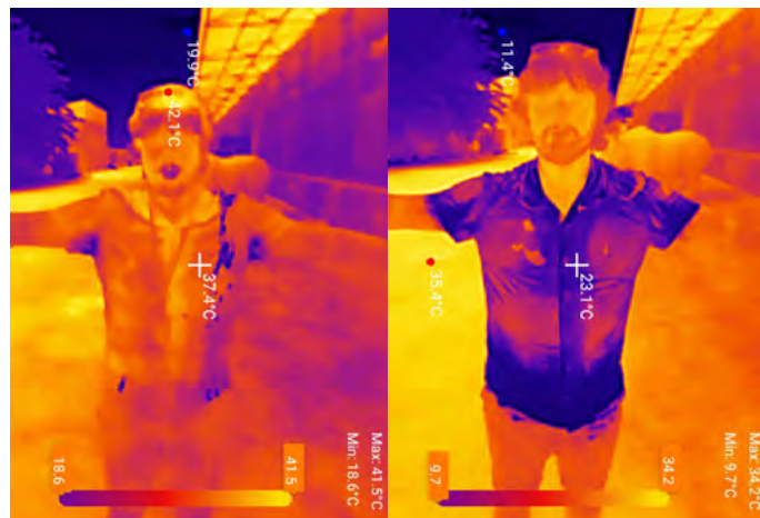
Température comparée d'une chemise en coton sèche (à gauche) et humectée (à droite). La température de surface chute de 14°C grâce à l'évaporation.
