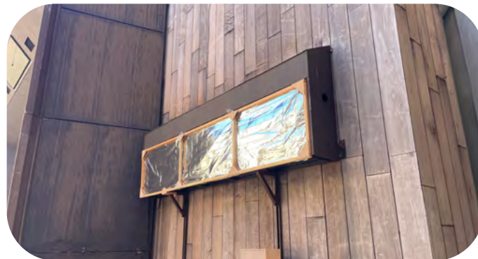
Festival d'Aix-en-Provence, Théâtre de l'Archevêché : protection DIY des écrans LED de surtitrage.
